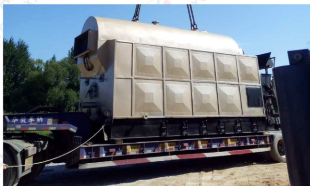
2016.12 河南盛鸿纺织有限公司4.2MW生物质热水锅炉 2016.12 4.2mw/h biomass hot water boiler in Henan Shenghong Textile Co.,Ltd
